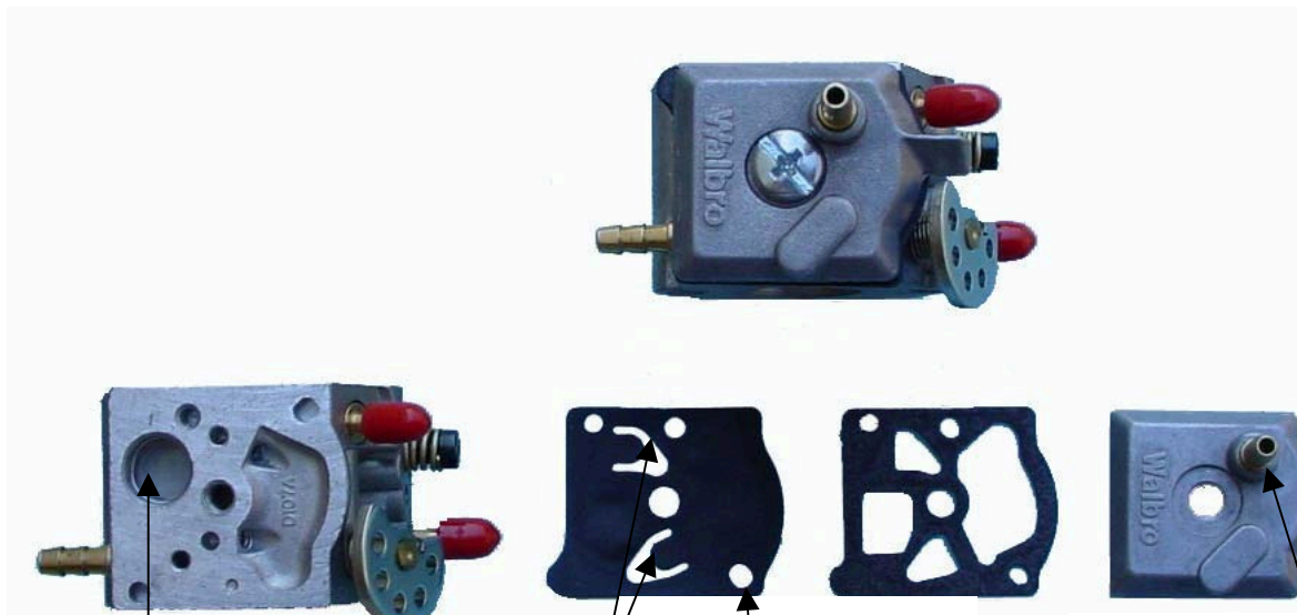
Entrada De Pulsos De Aire Para Accionar El Diafragma
